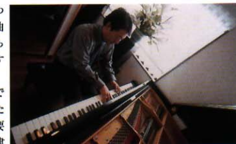
ピアノを調律するには、1mm以下の寸法を指先で感じとれる微妙な感覚が求められる。さまざまな道具を巧みに使い分けながら、ずれた音程やタッチを正確に直す。
