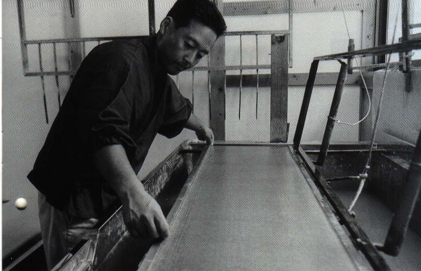
和紙づくりのハイライト、紙漉き。腕ですくうのではなく、腰と肩のバランスが大切だといふ。熟練すると自在に紙の厚さが調節できる。
